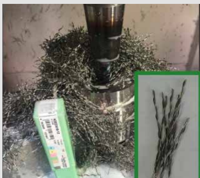
Стандартный инструмент: длинные и гладкие режущие кромки образуют длинную стружку, которая налипает и спутывается.
