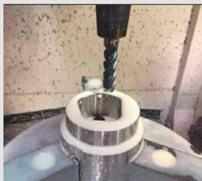
Специальный инструмент Walter: новая стружкоделительная геометрия обеспечивает образование сегментной стружки, которая легко отводится из зону резания.
